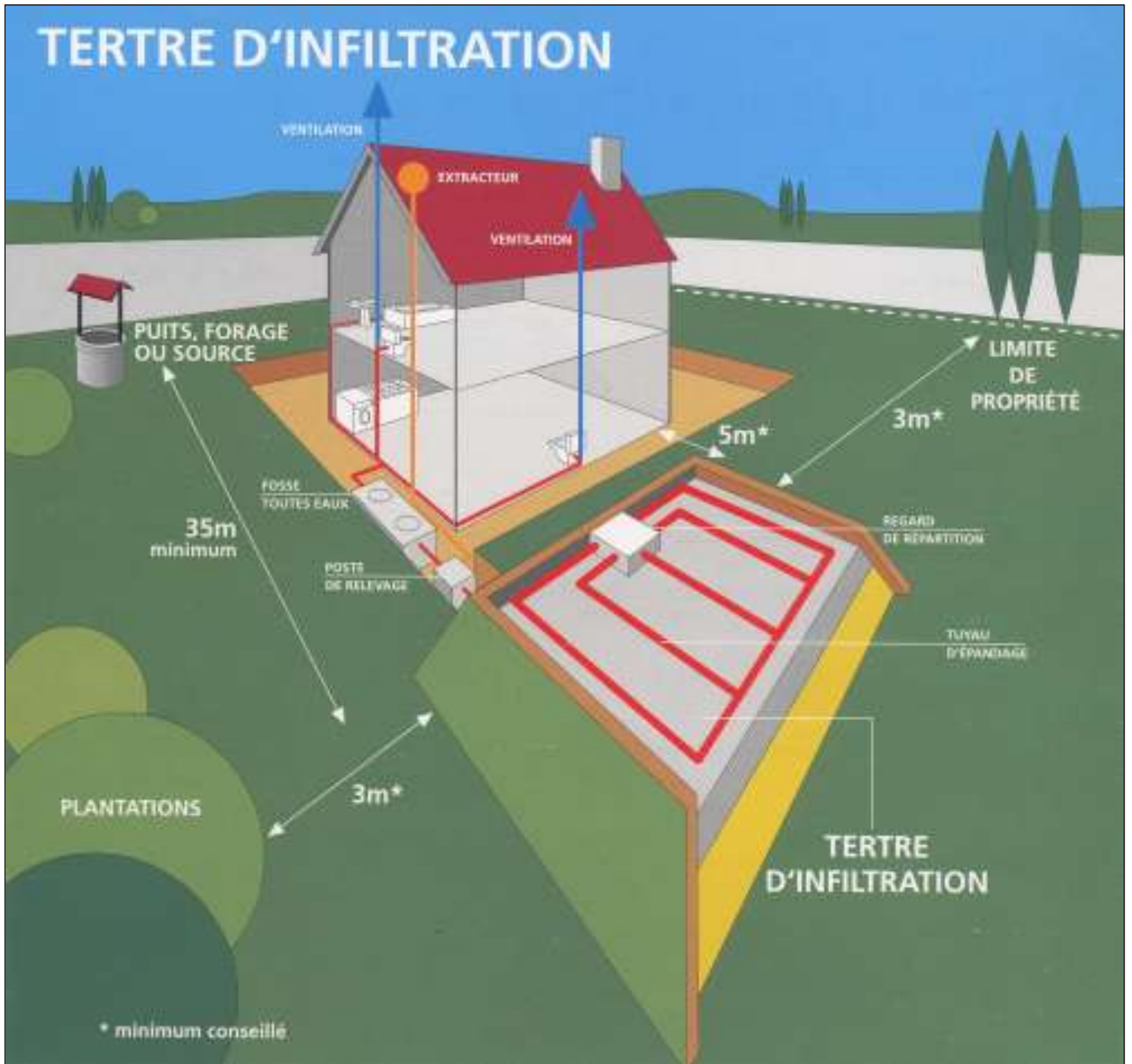
Schéma de principe du tertre d'infiltration
